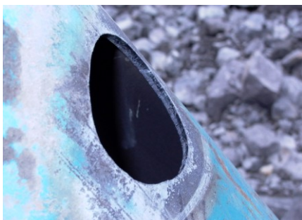
Hull i oksygenflaske etter påskyting, foto Harald Hovde AGA
