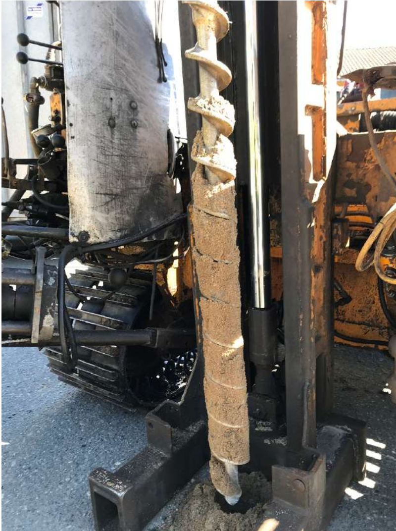
Figur 4: Bilde av prøve tatt opp fra punkt 3. Her ble det observert 0,6 m fyllmasser som besto av fin lys sand, over stein fylling. Det var ikke mulig å bore gjennom steinfyllingen med skovelbor.
