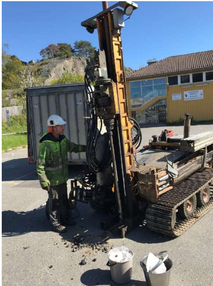
Figur 3: Borerigg fra Grunnundersøkelse AS som ble benyttet til uttak av jordprøvene.
