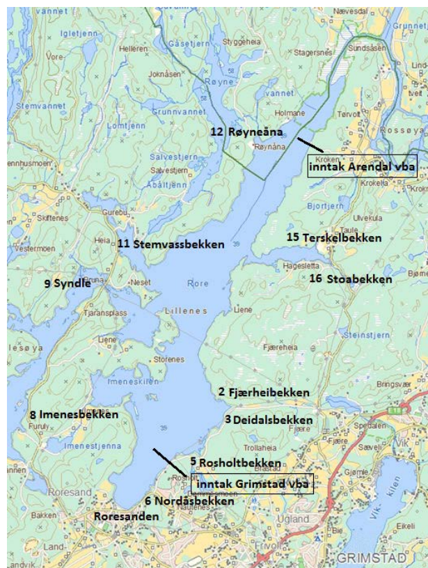
Figur 6.4 Tilløpsbekker og inntak til vannbehandlingsanlegg. Kartgrunnlag: NVE-Atlas.
