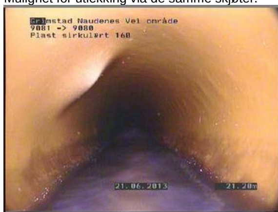
d) Eksempel deformasjon av rør, punktdeformasjon. Mest sannsynlig en stein som ligger mot røret på utsiden
