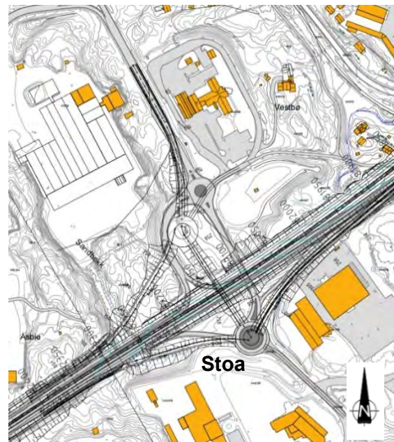
7-10 Til venstre: Forslag til kryssløsning med østvendte ramper (retning Oslo) ved Harebakken. Til høyre: Forslag til kryssløsning med vestvendte ramper (retning Kristiansand) ved Stoa.
