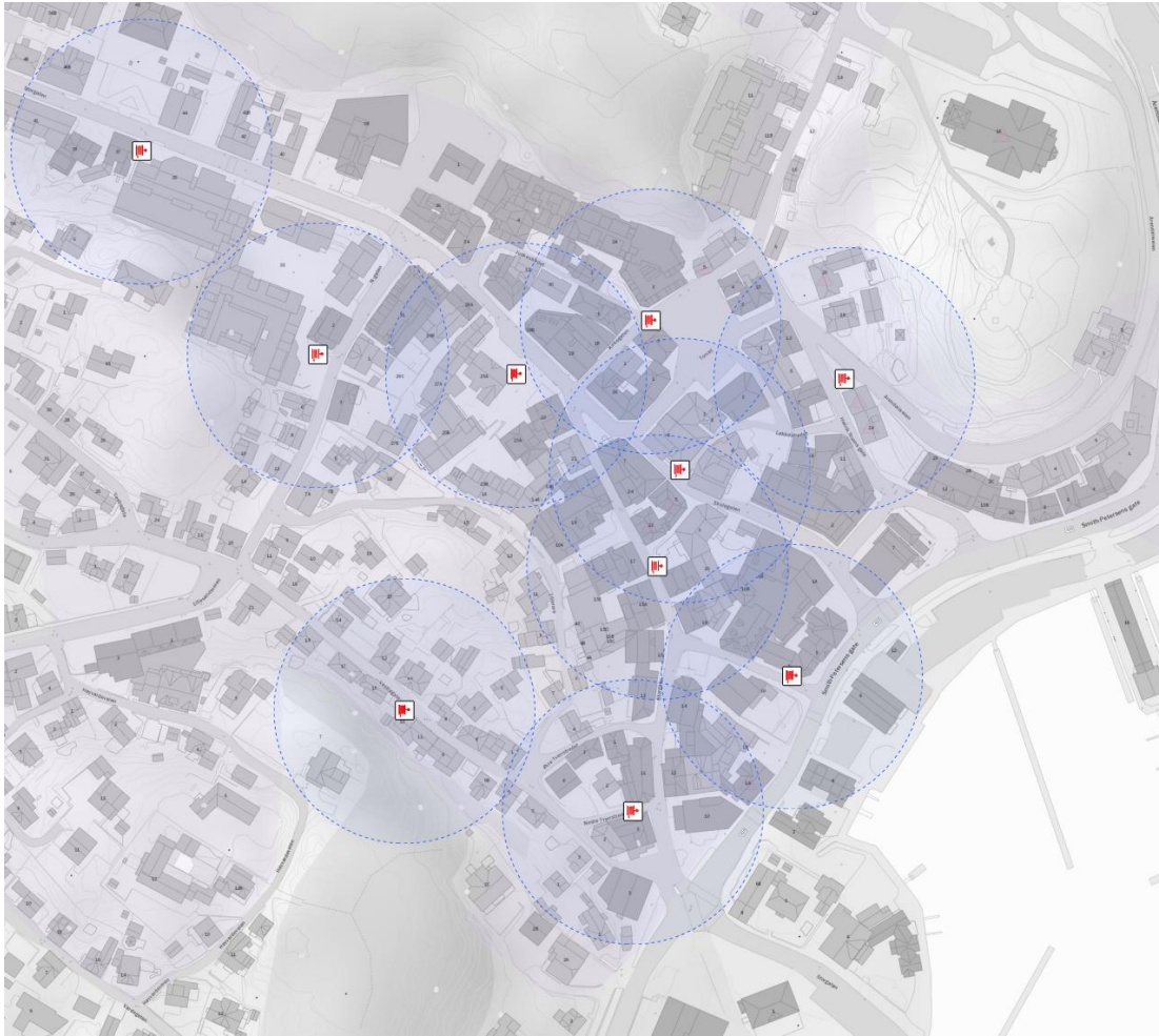
Figur 19: Kart viser slokkepostenes plassering i Sentrum og teoretisk rekkevidde for slangeutlegg.
