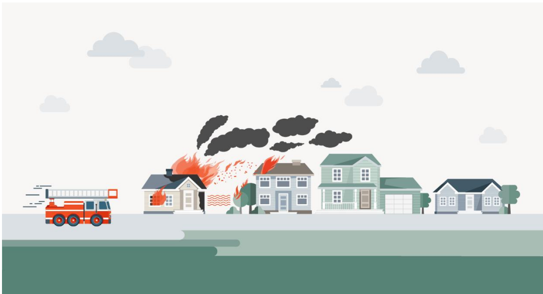
Figur 9: illustrasjon viser brannspredning via gnister/flyvebrann og varmestråling.
