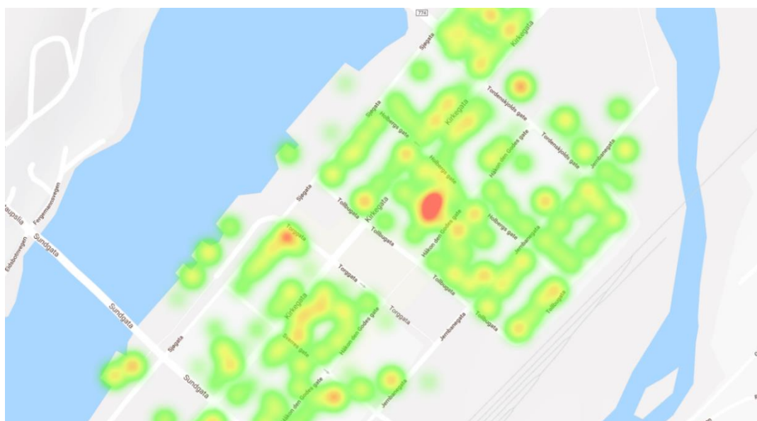
Figur 31: Eksempel på område hvor brannskallets tilstand er registret for hus i tett trehusbebyggelse. Røde områder indikerer økt risiko for brannspredning.
