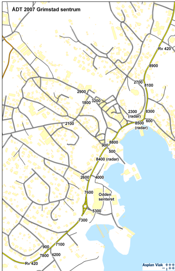
ADT basert på radartelling 3 snitt i uke 3 - 2007 og manuelle tellinger i 10 kryss ettermiddagsrush onsdag 17/1 og 2 kryss kl. 12-15 lørdag 20/1. Uke 3 utgjør her 80% av gjennomsnittsuke i året.
