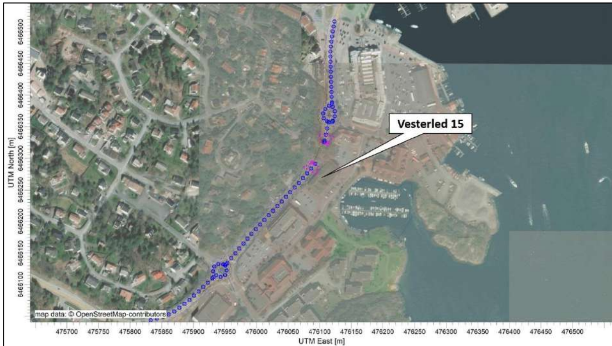
Figur 14: Vestrekningene (blå linjer) som inngår i beregningene. Rosa polygoner representerer arealkilder som følge av utslipp fra munningene til Vesterledtunnelen.
