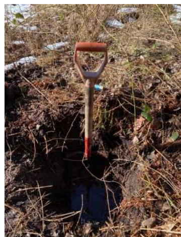
Gravehull fra midt i midt på tomt. Grunnvann ved 60cm.
